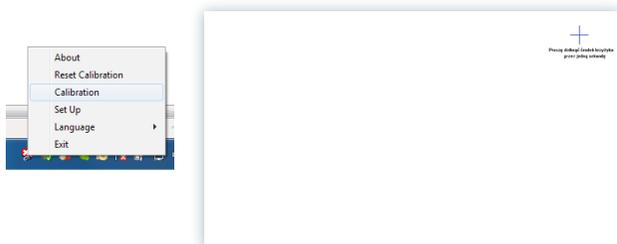
Pour effectuer la processus de calibration de manière correcte, il faut appuyer pendant environ 2 secondes la petite croix jusqu'à ce que le point de calibration change au point suivant. Une fois la calibration de tous les 4 points terminée, le tableau mémoriser les coordonnées de l'image affichée. Il faut refaire la calibration chaque fois après les modifications de la position de l'image affichée sur la surface du tableau.
