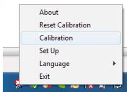
On effectue la calibration en touchant chacun des quatre points qui apparaissent.
